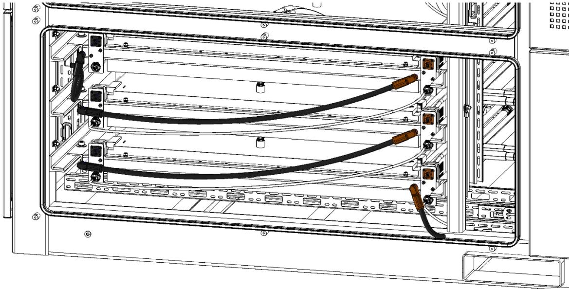
Abbildung 29: DC-Verkabelung Schubladen
