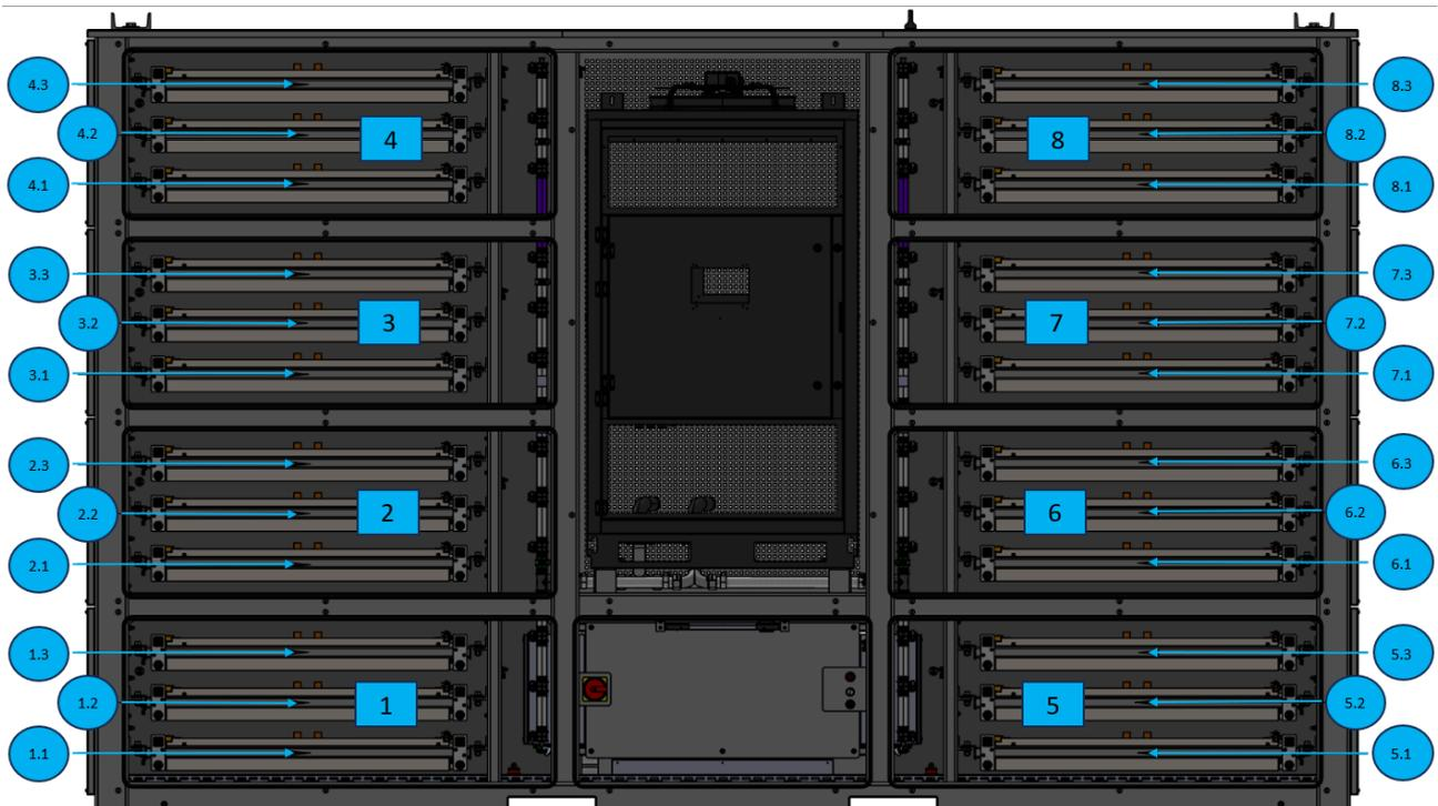
Abbildung 23: Bezeichnung der einzelnen Batterieschubläden
