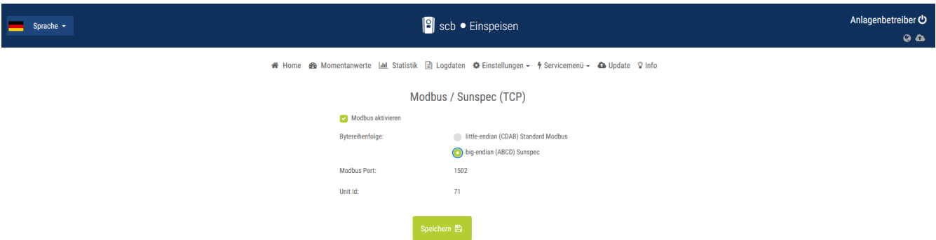
Abbildung 6. KOSTAL Weboberfläche – Modbus/Sunspec (TCP)
