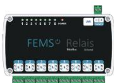
FEMS Relais 8-Kanal TCP FEM010
