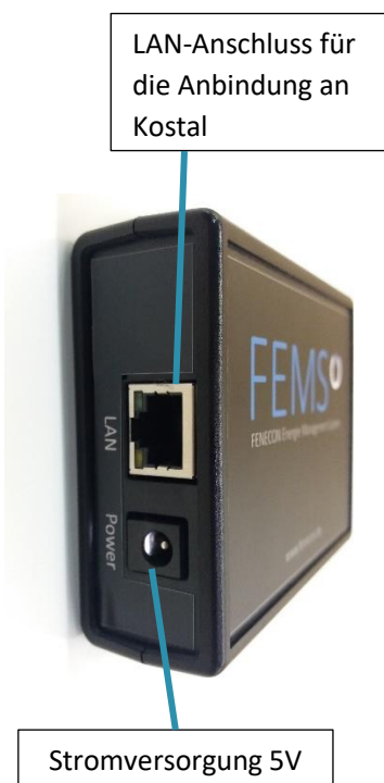
Abbildung 5: Anschlussübersicht FEMS
