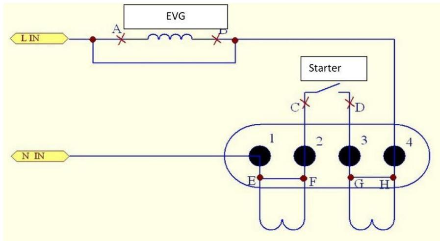
4. Trennen Sie die Verbindung zwischen C und D
