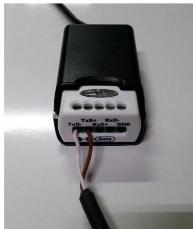
Abbildung 21: Verdrahtung am RS485 USB-COM-TB Adapter
