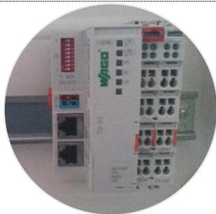
Montieren Sie den **WAGO Feldbuskoppler (750-352)** und bringen Sie dahinter die jeweiligen **FEMS Feldbus Klemmen** an. Den Abschluss des Feldbuses bildet die **WAGO Busendklemme (750-600)**.
