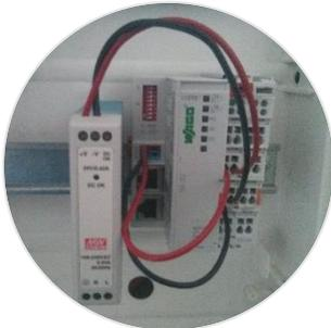
Verbinden Sie die **Feldversorgung** mit dem Schaltnetzteil:
